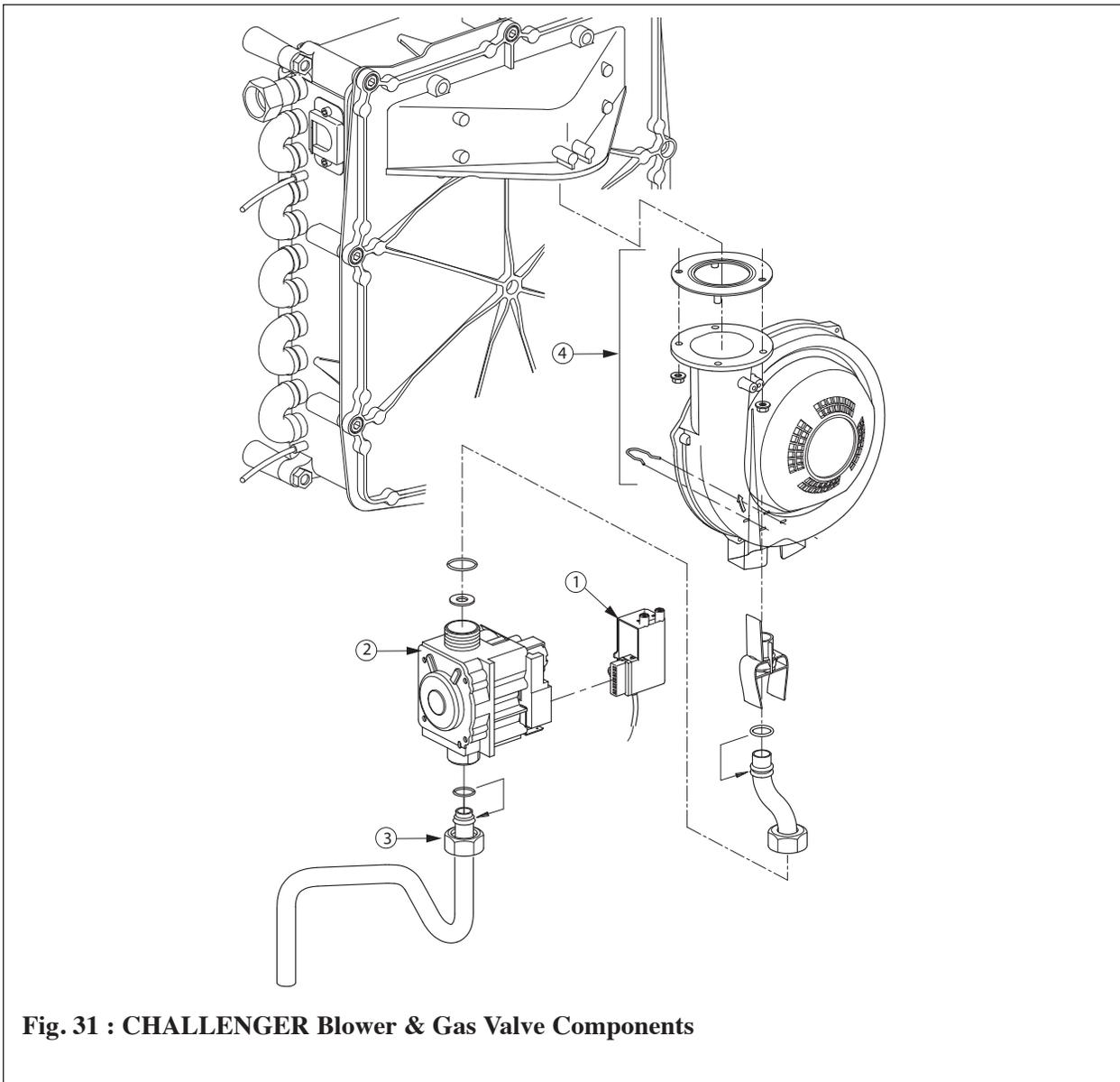
**Fig. 31 : CHALLENGER Blower & Gas Valve Components**
