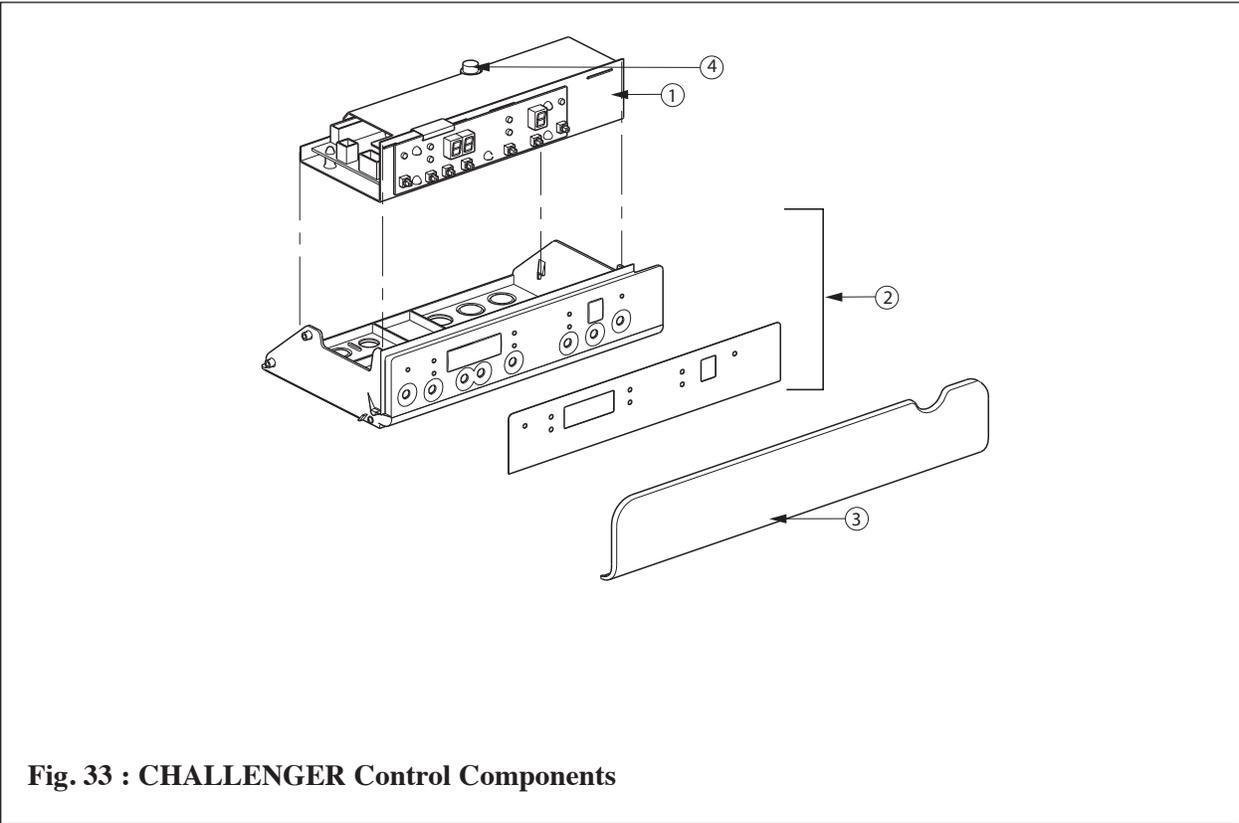
**Fig. 33 : CHALLENGER Control Components**
