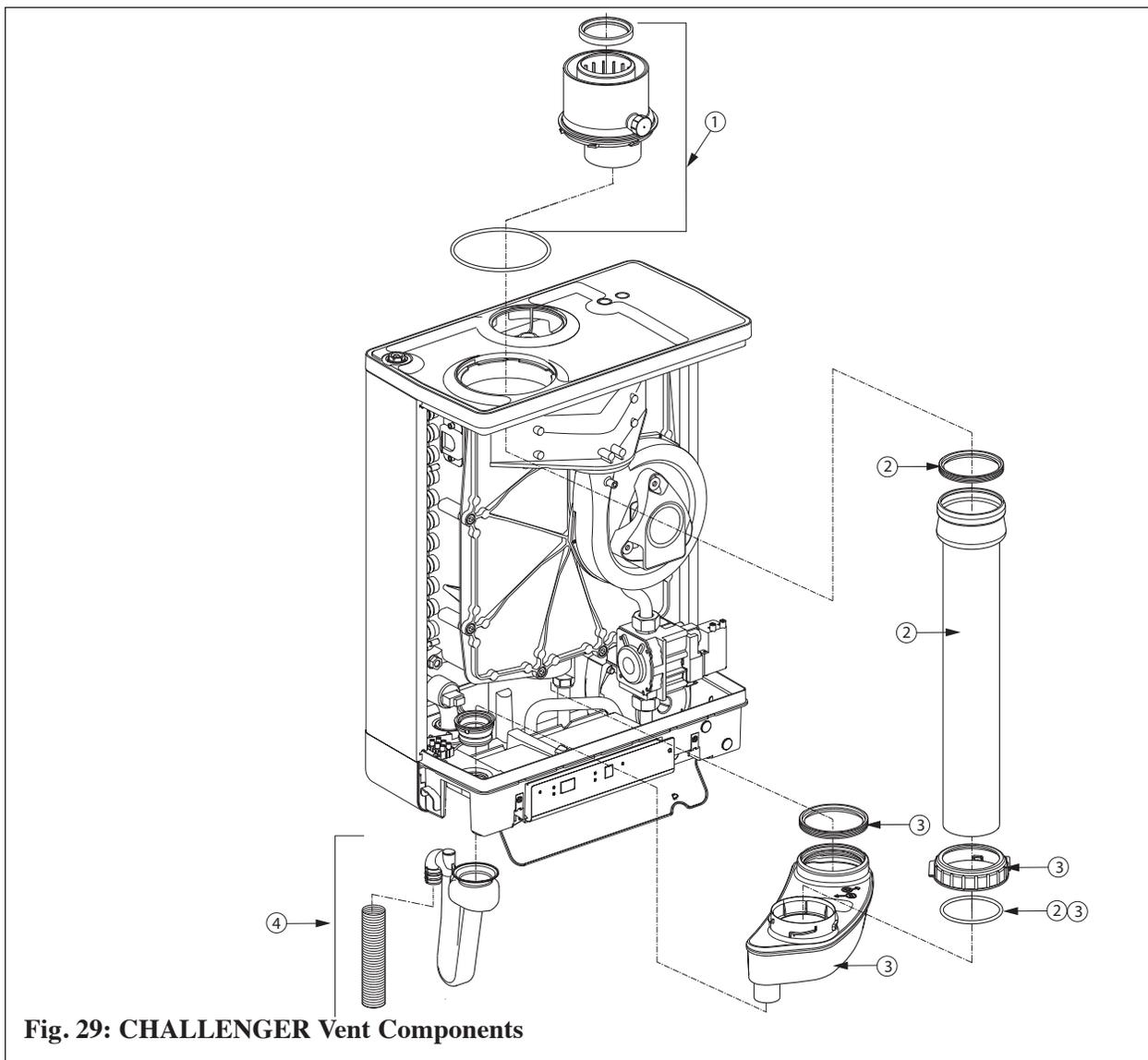
**Fig. 29: CHALLENGER Vent Components**
